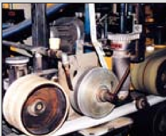
Нагреватели 5000 при сварке бесконечного шланга и ПВХ.
