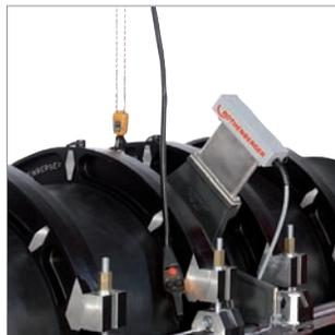
Прочное электрическое подъемное устройство.
