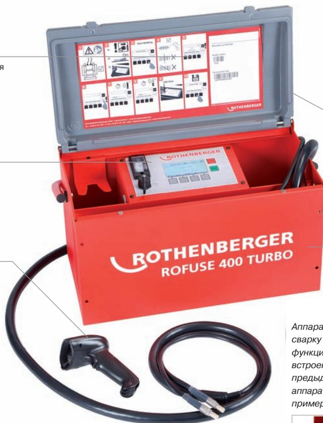
Аппарат рассчитан на более продолжительную сварку благодаря функции активного охлаждения: функция АС улучшает отвод тепла при помощи встроенного вентилятора. По сравнению с моделью предыдущего поколения (ROFUSE basic 48), аппарат ROFUSE TURBO способен серийно сварить примерно на 20% больше фитингов.
