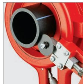
**Комплект состоит из:** пластмассового чемодана (№ 55017) с базовым устройством (№ 55030), внутренним гратоснимателем (№ 55018), 2 наборами вкладышей, держателем с резем с копирующей автоматикой (№ 55019).
