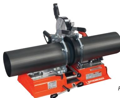
ROWELD® P 160 SANILINE базовая машина.
