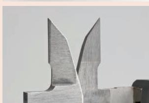
Губки с твердосплавными измерительными поверхностями
