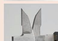
Губки с твердосплавными измерительными поверхностями
