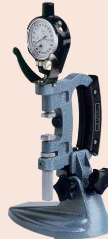
201-101 со стойкой 156-101 и индикатором часовного типа
