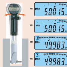
Индикаторный нутrometer ABSOLUTE Digimatic определяет минимальное значение (истинный диаметр) и автоматически сохраняет его.
