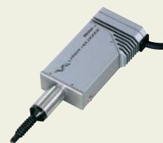
Прибор для линейных измерений с низким усилием
