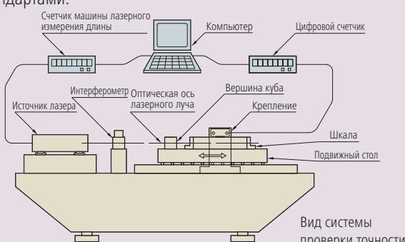
Точность шкалы в каждой точке определяется в виде величины погрешности, которая рассчитывается по следующей формуле:
