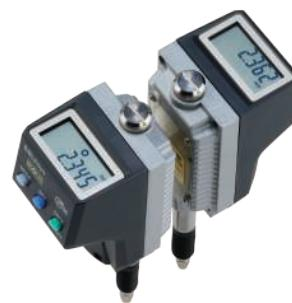
Гибкие возможности установки с переключением ориентации дисплея (использование верхней позиции)
