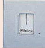
Постоянное малое измерительное усилие гарантировано только при расположении стрелки между двух контрольных линий в процессе измерения.
