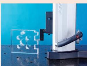
Пример применения QM-Height в плавающей воздушной подвеской
