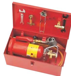
В наборе: безопасная рукоятка с соединением М 14 x 1 (№ 31989), паяльник с камерой сгорания (№ 32048), плоское медное жало 350 г (№ 32042), пропановый шланг 2,5 м (№ 32201), ключ (№ 32073), безопасная зажималка (№ 32077), запасные кремни (№ 32079), пропановый регулятор (№ 32082), штуцер для заполнения (№ 32207), пропановый баллон 0,5 кг (№ 33079), ключ (№ 35530), стальной чемодан (№ 35487)
