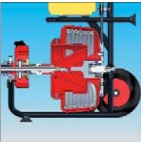
Защита спирали благодаря принудительному направлению в барабане
