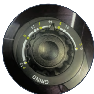
Настройка степени затемнения от 5 до 13 DIN
