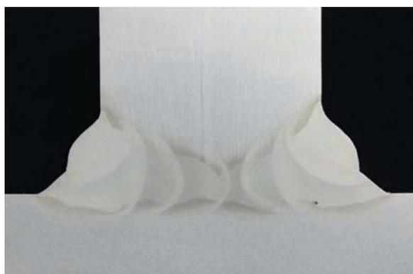
S355,  $t = 30$  мм, двусторонний шов DHV (двойной половинный V-образный шов) с углом раскрытия кромок  $35^\circ$ , без воздушного зазора, без строжки или шлифования обратной стороны корня
