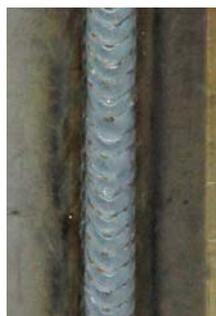
Сварка стали методом superPuls
