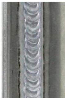
Сварка алюминия методом superPuls
