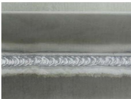
Угловой шов таврового соединения, лист толщиной 1 мм, AlMg, аргон
