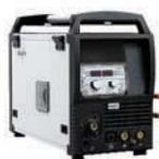
Механизм подачи горячей/холодной проволоки
