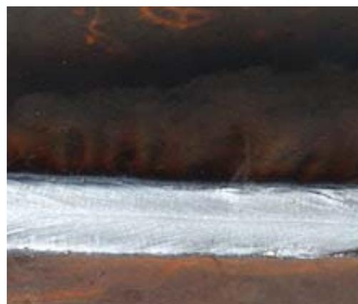
S355,  $t = 10$  мм, тавровый шов, угловой шов таврового соединения без разделки кромок
