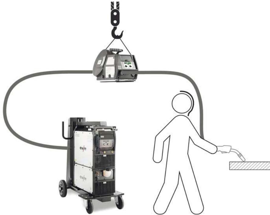
**R50 7POL** установлен на источнике тока в качестве второго блока управления
