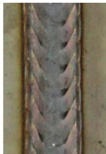
Сварка CrNi методом superPuls
