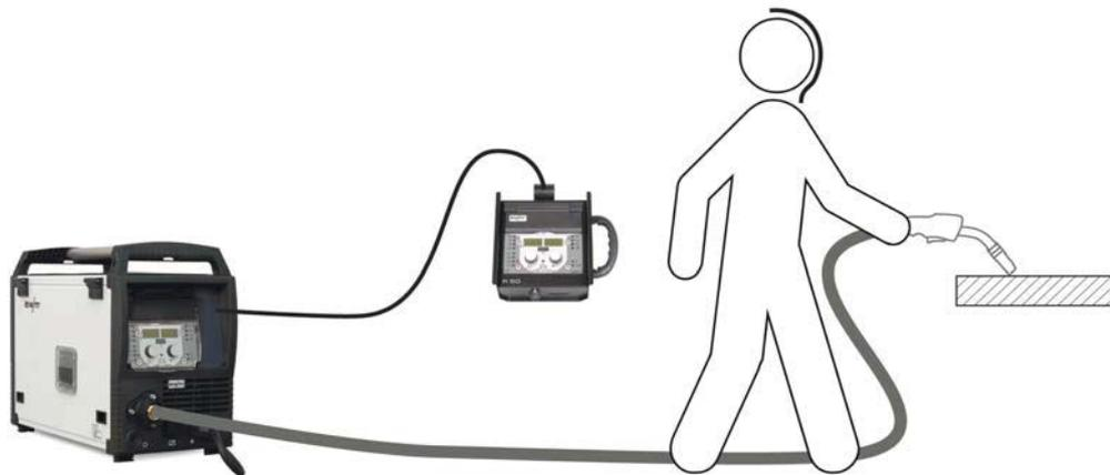
**R50 7POL** в качестве второго мобильного блока управления с компактным источником тока
