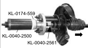
Выпрессовка шарнирного вала с помощью гидравл.цилиндра 17 т.
