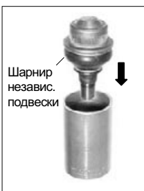
Рис. 2: Запрессовывание шарнира независимой подвески.
