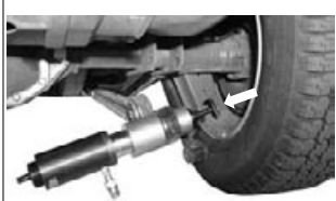
Демонтаж резинометал. сайлентблока (задний мост)
