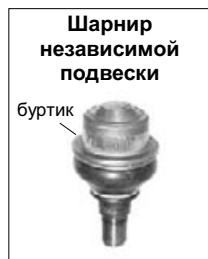
Рис. 1: Выпрессовывание шарнира независимой подвески.
