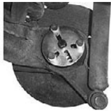
Выпрессовка фланца шарнирного вала.
