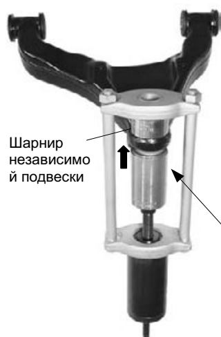
Рис. 2: Запрессовывание шарнира независимой подвески.
