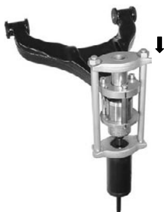
Рис. 1: Выпрессовывание шарнира независимой подвески.
