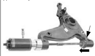
Демонтаж резинометал. сайлентблока
