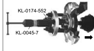
Выпрессовка шарнирного вала с помощью гидравл. шпинделя 12 т.
