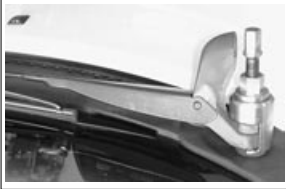
Снятие рычага стеклоочистителя нажимным инделем
