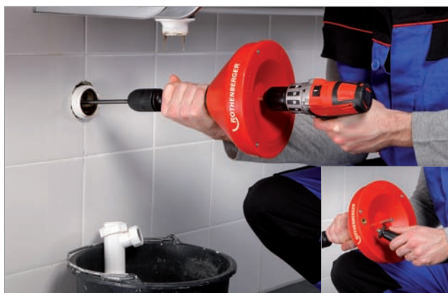
Привод от аккумуляторной дрели.
