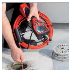
Обследование ливневых труб.
