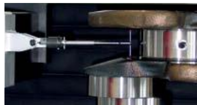
Дополнительная контактная система сканирования BTS 150, предназначенная для измерения межцентрового расстояния и осевого эксцентриситета.
