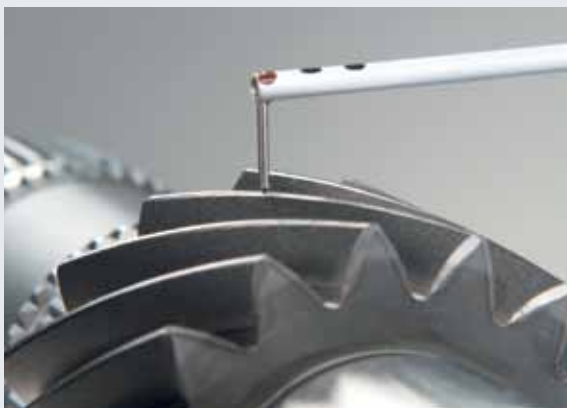
Измерение шероховатости и контура за один проход
