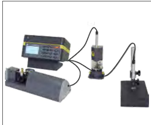
Одновременное использование 3-х щупов с передачей данных по трем каналам
