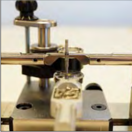
Измерение малых деталей на плавающем столике
