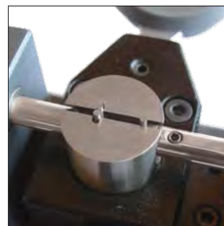
Столик с 3-х точечной системой измерения внутреннего диаметра 2.5 - 4 мм
