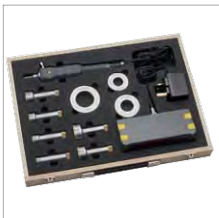
Набор: 6 измерительных головок, 3 установочных кольца, дисплейный блок D50S, рукоятка со щупом, блок питания
