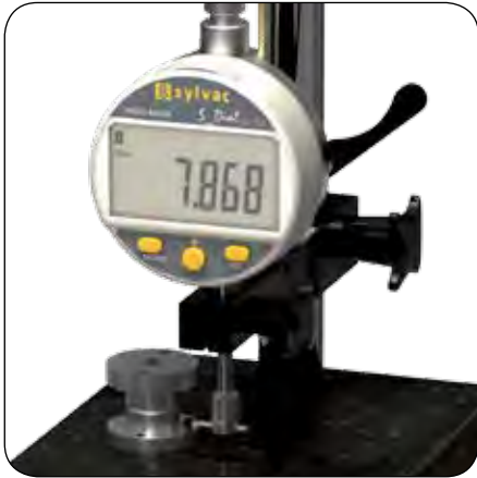
Измерение высоты паза S_Dial WORK с измерительной вставкой 905.2207
