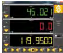
Отображение результатов измерения с нескольких инструментов с цветной индикацией допусков
