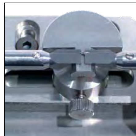
Стандартный XYZ предметный столик и ножевидные измерительные вставки
