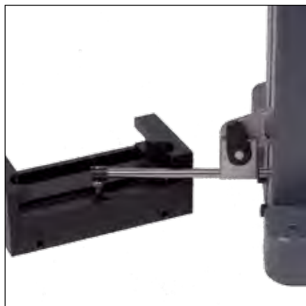
Измерение глубины (930.2108 и 905.2204)
