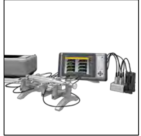
Индуктивные щупы совместно с мультиплексором M-Bus и дисплейным блоком D300S.
