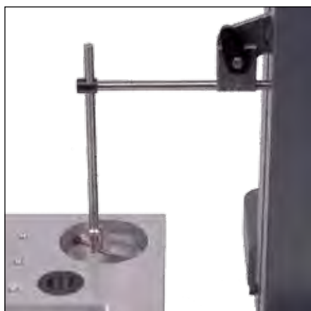
Измерение высоты внутреннего паза (930.2108, 930.2110 и 905.2207)
