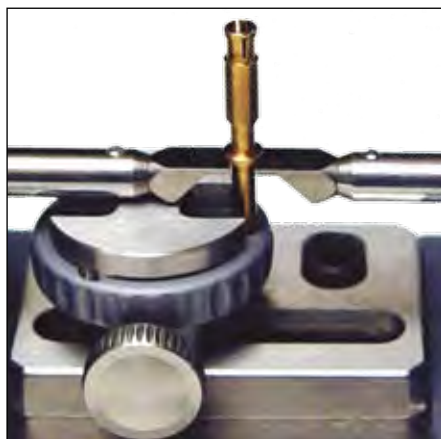
Универсальный XYZ столик с винтом микроперемещения. По запросу
