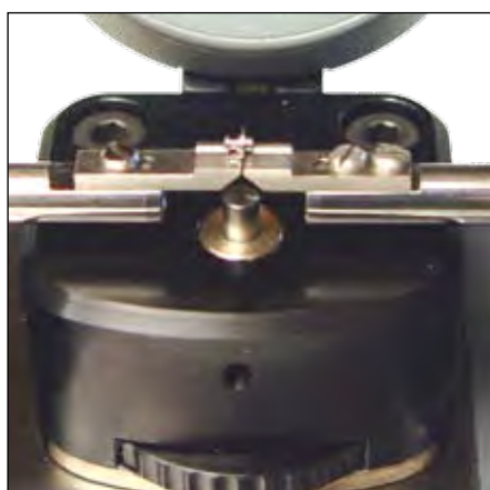
Предметный столик с пластиной \varnothing 3 мм и винтом микроперемещения. Индикация перемещения по высоте с помощью S233
