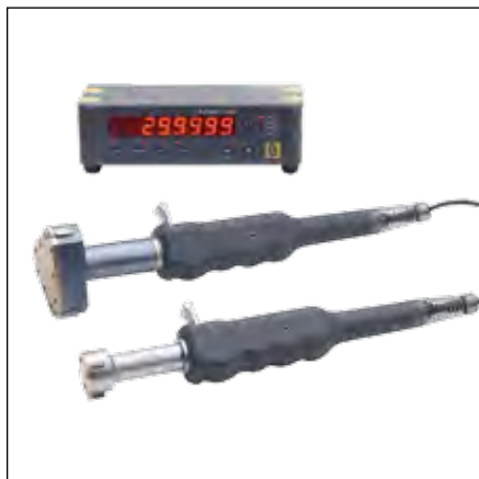
Подключение двух нутромеров к одному дисплейному блоку
