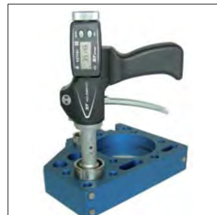
Измерение диаметра с системой XTH
