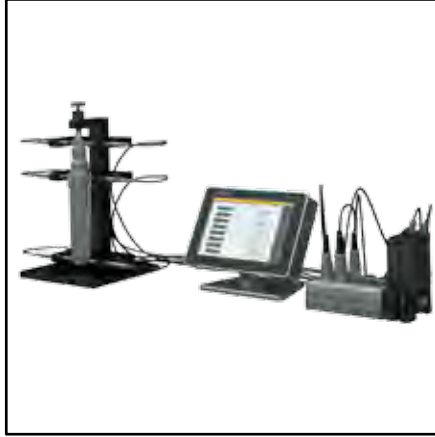
Индуктивные щупы совместно с мультиплексором M-Bus и дисплейным блоком D400S.
