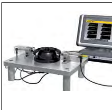
Подключение нескольких щупов с использованием блока D200S
