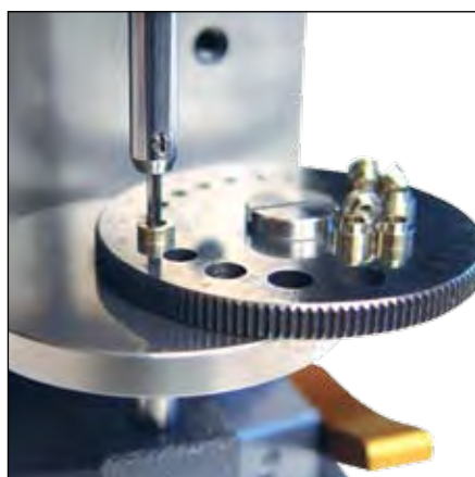
Измерение малых деталей с PS15BV+ и поворотным держателем с отверстиями
