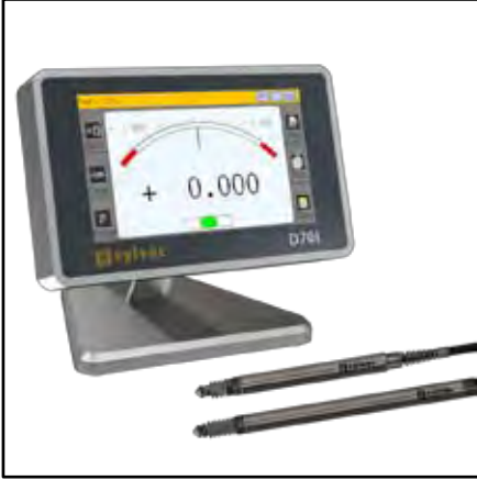
Использование щупов совместно с дисплейным блоком D701.
