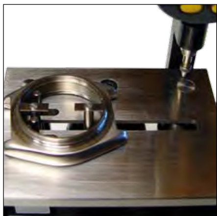
Измерение внутреннего диаметра с LVS 50
