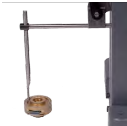
Измерение глубины (930.2108 и 930.2105)
