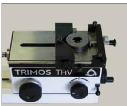
Калибровка гладких калибр-колец (THV-260)
