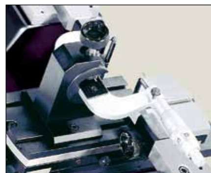
Проверка микрометров (HPA-1/TULM14)
