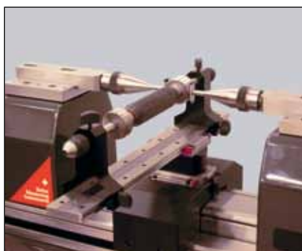
Проверка резьбовых калибр-пробок (HPA-1/ TEL6/3P/0.17-3.2/S6.5/LABC-15)
