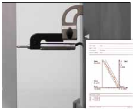
Проверка отклонения от перпендикулярности и использованием доп. щупа
