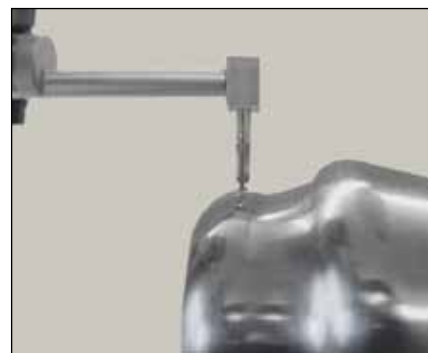
Измерение шероховатости полированных деталей (TA-MS-607)
