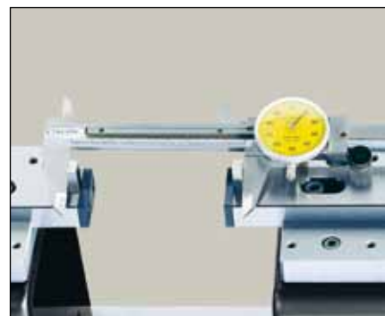
Проверка штангенциркулей (TEL5.10)
