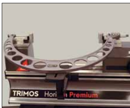
Проверка больших микрометров (TEL5/TEL11/LABC20)
