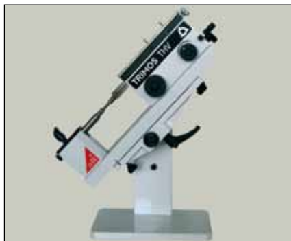
Настраиваемый суппорт для приложения постоянного измерительного усилия (THV-200)
