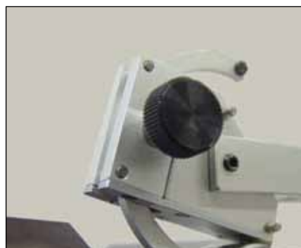
Измерение шероховатости в радиальном направлении (TA-MS-621)
