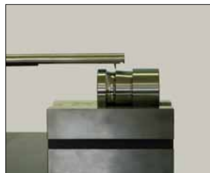
Измерение параметров контура TR ProfileE DH-8/VHF (TA-MS-650)
