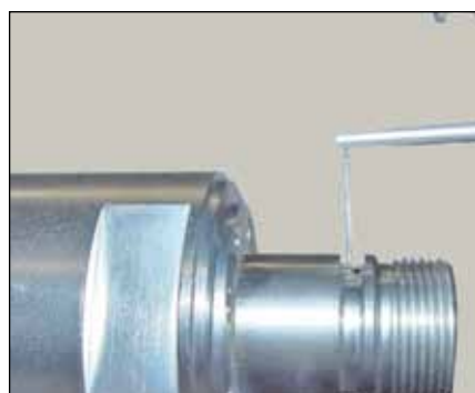
Измерение в углублениях (TA-MS-609)
