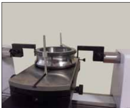
Измерение внешнего диаметра дорожки качения подшипника в режиме ЧПУ
