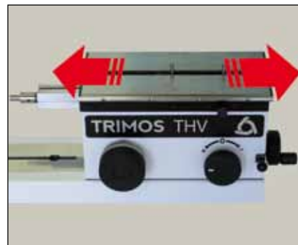
Плавающий стол для проведения более точных измерений внутренних размеров
