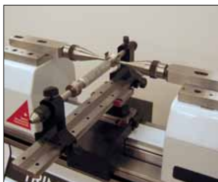
Измерение среднего диаметра резьбовых калибр-пробок (HPA-1/ TEL6/3P/0.17-3.2/S6.5/LABC-15)
