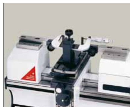
Проверка микрометров (HPA-1/TULM14)
