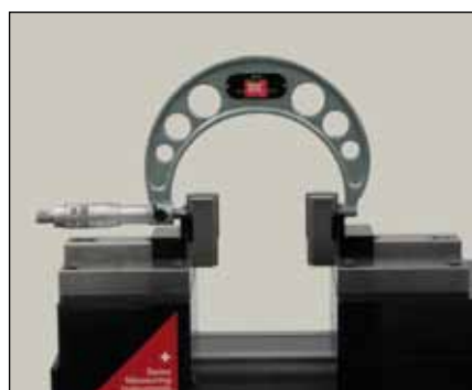
Проверка микрометров (TEL5/TEL11)
