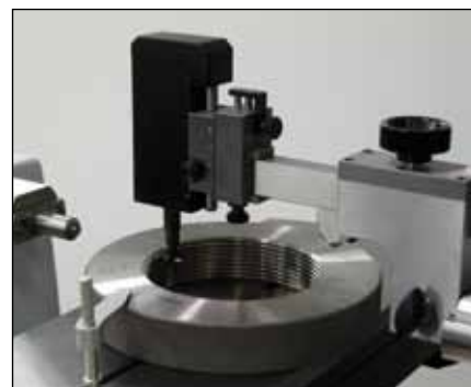
Калибровка резьбовых калибр-колец (TA-MS-370/TEL75/TA-SU-354)
