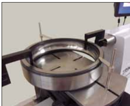
Измерение внутреннего диаметра дорожки качения подшипника в режиме ЧПУ
