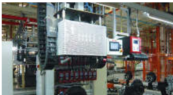
Один блок питания с функцией аварийной остановки - переключателями Ethernet - Multicombox - прерывателями цепи
