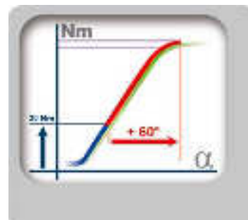
Затяжка с заданным крутящим моментом и дополнительным поворотом угла (момент + угол)
