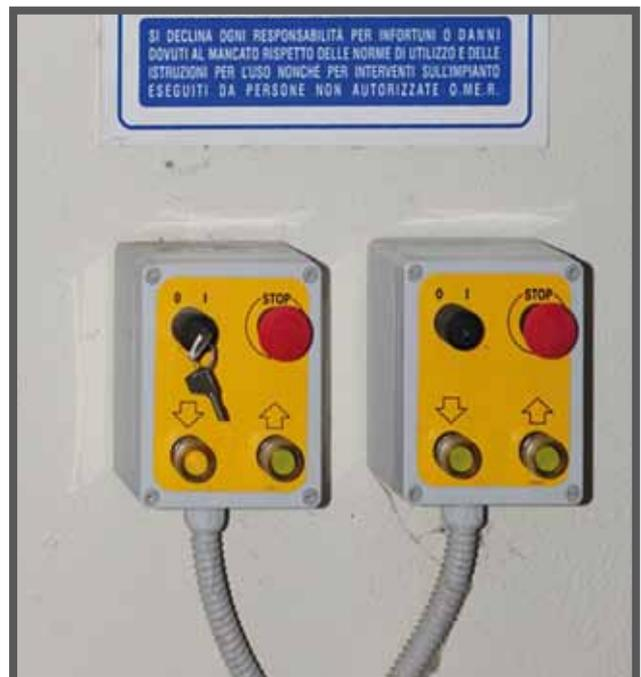
На пульте управления имеется кнопка подъема, кнопка спуска, грибовидная кнопка аварийной остановки, а также главный выключатель с ключом. Кроме того, на пульте управления имеются рисунки, поясняющие необходимые для управления системой команды.
