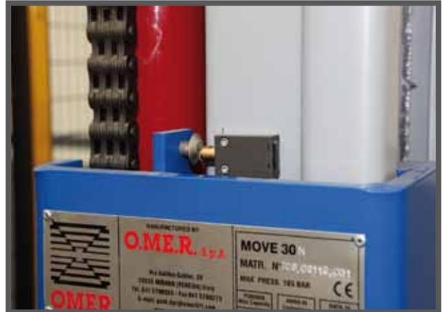
В состав системы Move 30 N входят различные концевые выключатели. Один из них останавливает платформу на указанном уровне и обеспечивает безопасную погрузку или выгрузку автомобиля.
