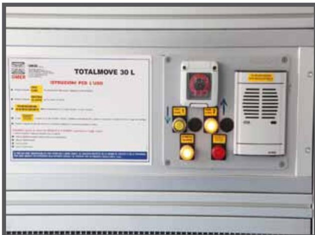
На этой фотографии показан пульт управления, установленный на платформе и предназначенный для безопасного управления. Здесь же показан коммуникатор, подключенный к встроенному в систему телефонному аппарату (стандартная комплектация), в памяти которого может храниться семь номеров для повторного набора. Этот телефон поддерживает коды двадцати двух стран, что позволяет адаптировать его к любой национальной телефонной системе.
