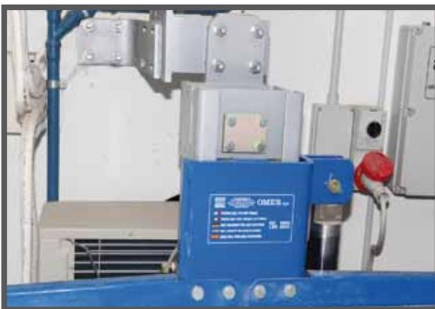
Скользящий вдоль колонн упор надежно закреплен на платформе и внешней стороне вала поршня, что и позволяет ему работать указанным образом. Прочность данной системы является самой главной характеристикой ее качества и безопасности для автомобилей.
