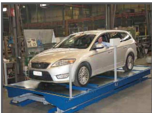
Как видно на фотографии, водитель управляет подъемной платформой, находясь в автомобиле
