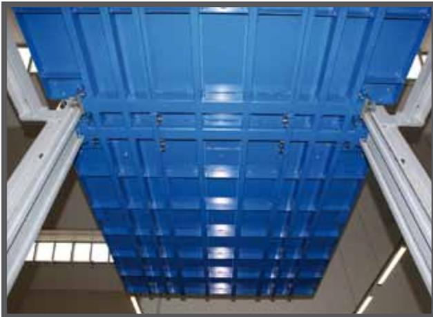
Основным преимуществом данной подъёмной платформы является чрезвычайно прочная базовая конструкция, которая не сгибается даже под весом, соответствующим грузоподъемности системы - 3000 кг. Устойчивость этой конструкции позволяет достаточно легко и безопасно устанавливать автомобиль на платформу.
