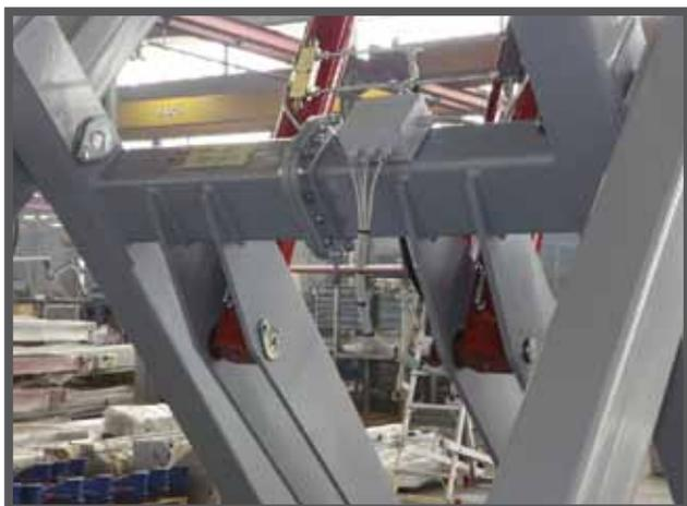
На этой фотографии показана фланец на центральной балке с распределительной коробкой для подключения электрических систем.
