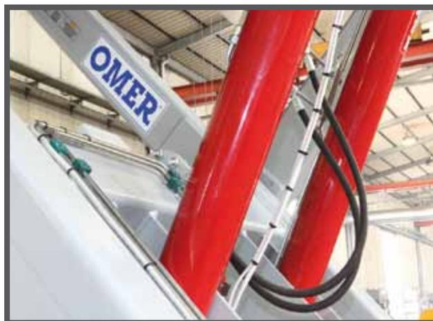
В центральной части системы имеется два подъемных гидроцилиндра, которые крепятся на подвижных частях ножниц, что позволяет свести любые затруднения к минимуму.
