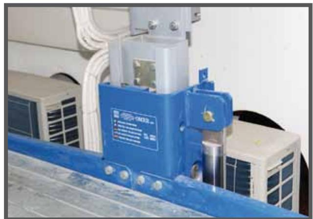
Закрепленный на платформе упор соединяется с верхним концом вала поршня, что позволяет ему скользить вдоль колонны.
