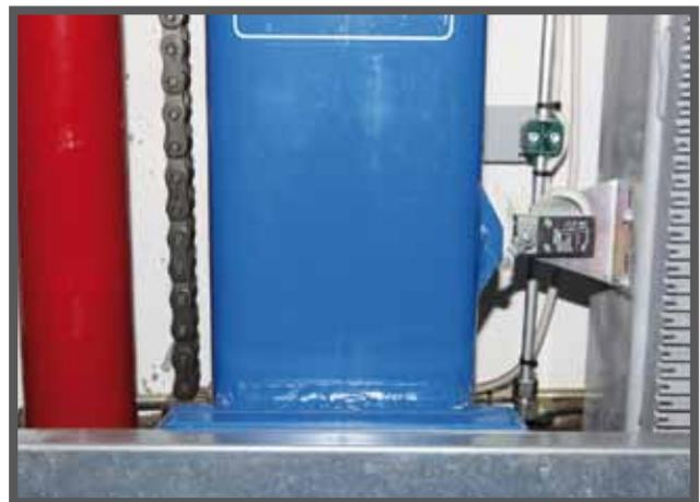
Фотография показывает работу концевого выключателя остановки, который находится на опоре напротив концевого выключателя торможения, но имеет более короткий рабочий кулачок.
