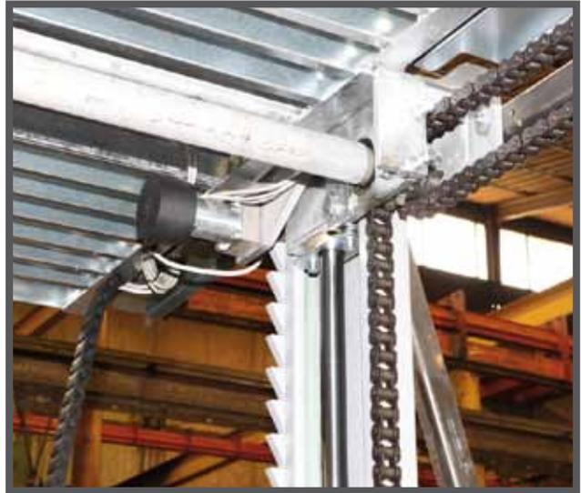
На этой фотографии показано, что на каждую из длинных сторон платформы приходится по две цепи, которые полностью входят в зацепление с шестернями торсионных валов. Если удерживать цепи натянутыми, наклоны системы будут исключены
