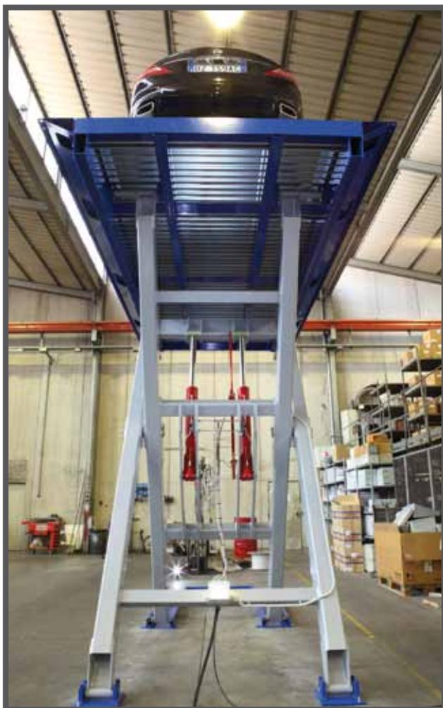
Нижняя часть платформы опирается на стальной каркас, который обеспечивает максимальную надежность работы системы.
