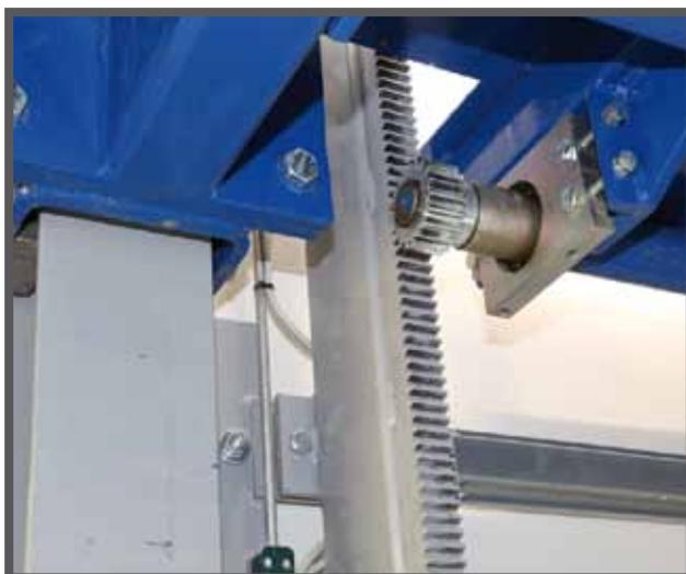
На следующем изображении платформы показаны различные элементы, обеспечивающие ее жесткость и исключающие ее перегибы даже при смещении нагрузки в сторону или от центра.
