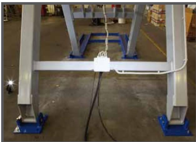
Распределительная коробка, служащая для подключения щита питания, расположена на нижней перекладине между неподвижными опорами. Благодаря этому она легко доступна. В целях обеспечения быстроты и простоты монтажа все элементы системы поставляются предварительно установленными на платформе.
