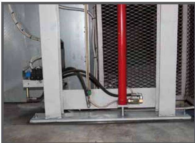
Конструкция состоит из двух колонн, сваренных вместе в единый блок, что обеспечивает системе повышенную жесткость, а также расположенного по центру гидравлического цилиндра (производитель - компания Omer SPA), который подключен к специальному блоку управления.
