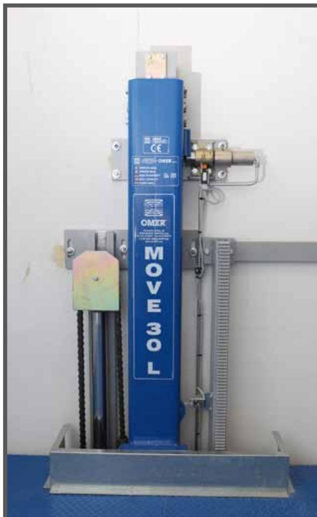
На этих фотографиях показан механический стопор, предназначенный для блокировки платформы на уровне остановок.
