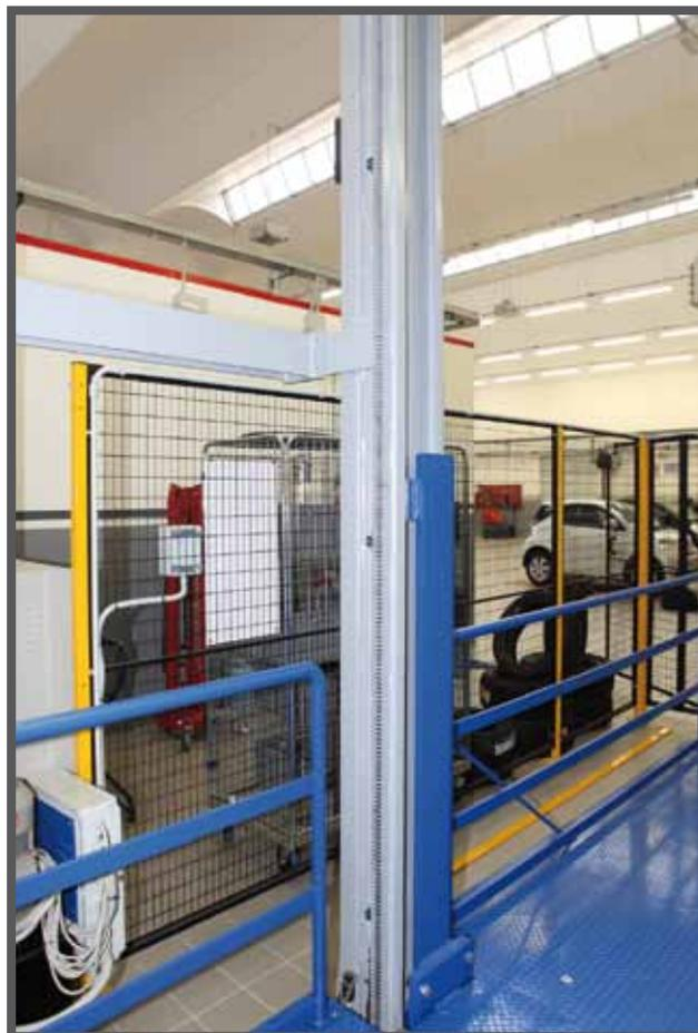
При необходимости непосредственно на платформе могут быть установлены съёмные или стационарные защитные ограждения, которые обеспечат автомобилю дополнительную безопасность во время перемещения.
