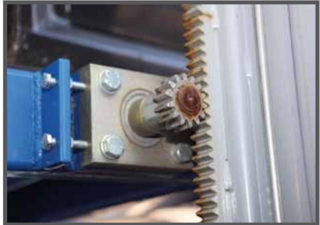
На этой фотографии опоры торсионного вала показано, что положение шестерни относительно зубчатой рейки может быть отрегулировано сдвигом опоры
