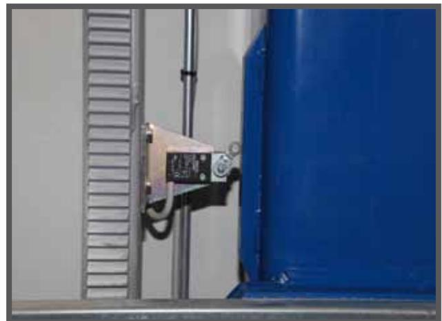
На фотографии снизу показана регулировка концевых выключателей торможения и остановки, а также длина рабочего кулачка (длиннее, чем у выключателя остановки).
