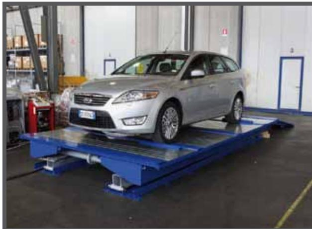
Система REX Gold 30 не только обладает значительной прочностью (ее суммарная грузоподъемность достигает 4000 кг), но и очень компактна (требуется приямок глубиной всего 51 см).
