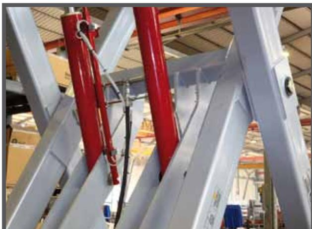
Гидравлическая система платформы состоит из двух поршней (производитель - компания Omeg), оснащенных дифференциальными клапанами, реагирующими на перепады давления масла. При возникновении таких перепадов (например, при поломке гидравлического соединения или при сильных утечках масла) электромагнитные клапан незамедлительно перекрывает связь между поршнями и этими гидравлическими соединениями, предотвращая вытекание масла
