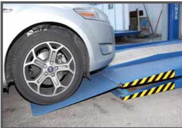
Для снятия автомобиля с верхней платформы используются специальные мостки, которые постоянно соединены с этой платформой.
