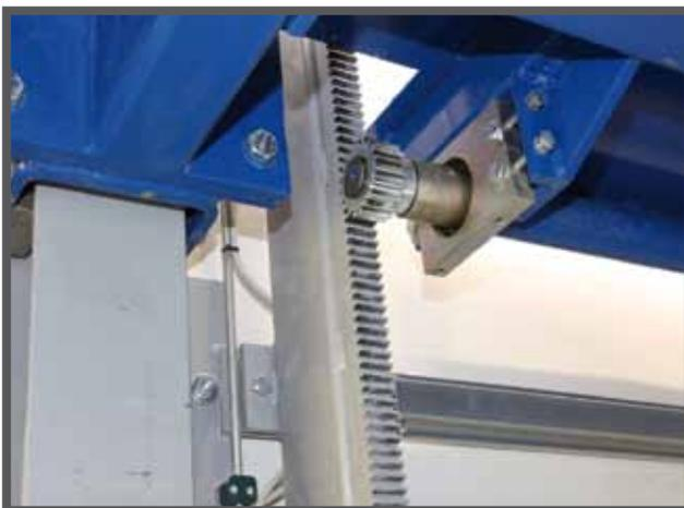
Головная шестерня торсионного вала оснащена кольцом с углублениями (по одному на каждом конце), которое входит в зацепление с зубчатой рейкой и перемещается вдоль нее (одна рейка на колонну). Торсионный вал устанавливается на закрепленных на зубчатых рейках опорах, положение которых может быть изменено.
