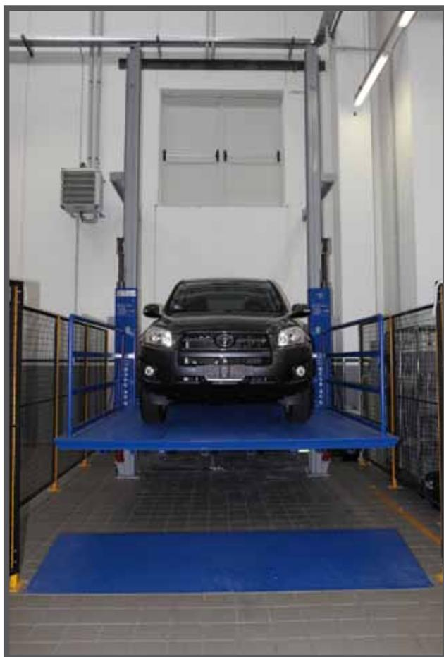
Автомобиль может быть установлен на платформу любой стороной: передом или задом. Это никак не сказывается на работе подъемника.
