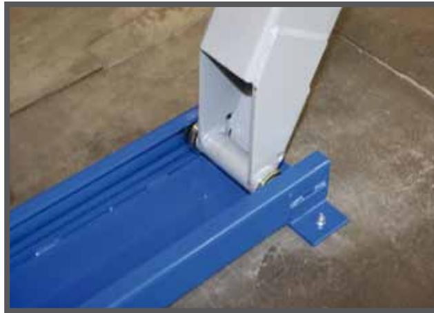
Две направляющих, по которым перемещаются опоры платформы Rex PF, закреплены на полу механическими анкерами.
