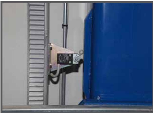
На этой фотографии показана регулировка концевых выключателей торможения и остановки, а также длина рабочего кулачка (длиннее, чем у выключателя остановки).
