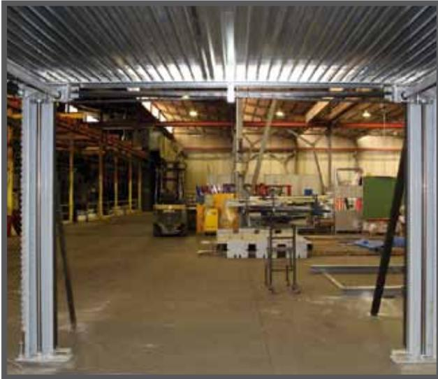
Система оснащена двумя торсионными валами (по одному на каждую пару колонн), которые установлены вдоль коротких сторон платформы. При этом торсионные валы являются частью системы выравнивающих цепей, которые обеспечивают идеальное выравнивание платформы и предотвращают любые наклоны во время движения.
