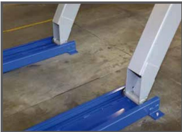
Ролики оснащены износостойкими пластиковыми втулками, которые предотвращают трение и продлевают срок службы системы.
