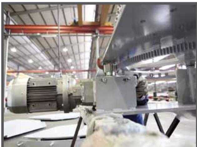
Одним из элементов, поддерживающих центральный поворотный штырь, является мотор-редуктор, основными особенностями которого являются: простота установки и сборки.
