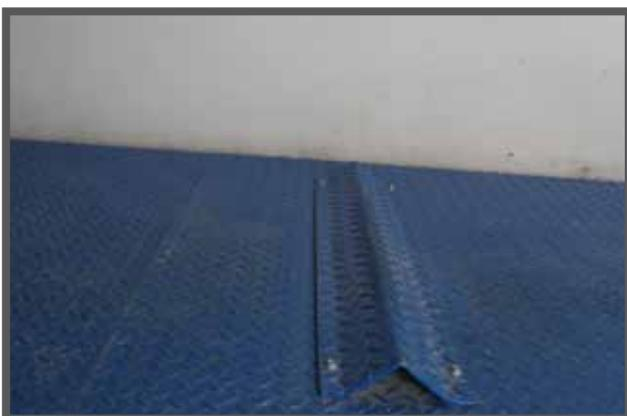
Упор для передних колес гарантирует, что автомобиль установлен надлежащим образом и не сместится во время перемещения платформы. Еще один такой упор находится в задней части платформы.
