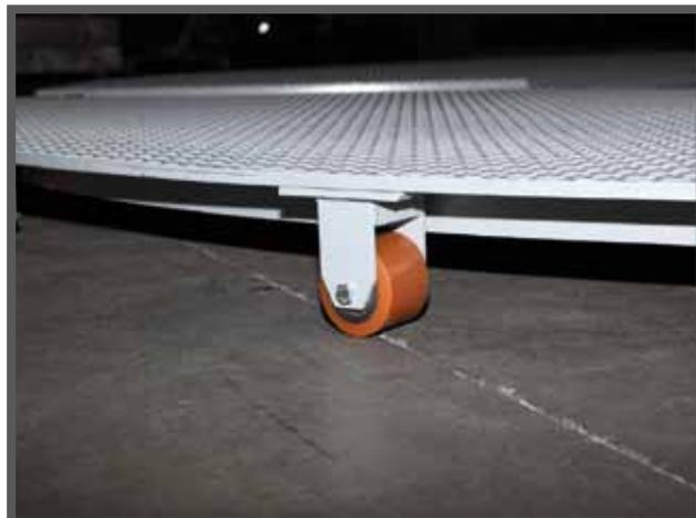
Для крепления полиуретановых колесиков используются приваренные к платформе U-образные держатели с механическими штифтами.
