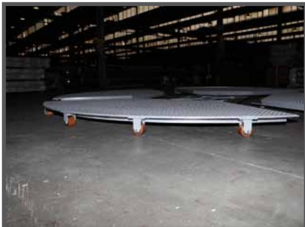
Каждый из секторов платформы Ralla 25 оснащен четырьмя полиуретановыми колесиками. Это позволяет свести к минимуму площадь участков платформы, нагрузки на которые не передаются на соответствующие опоры. Кроме того, это позволяет предотвратить деформацию платформы, которая может иметь место при неравномерном распределении нагрузки. Наконец, благодаря этому удастся значительно снизить уровень шума.
