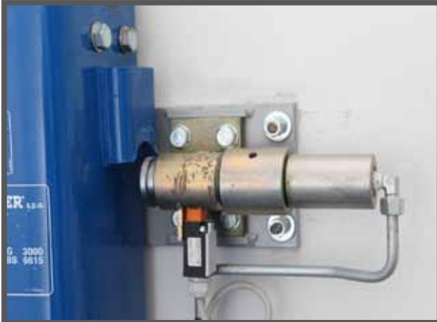
Упор платформы проходит за точку механической блокировки, что позволяет ему выдвинуться вперед.
