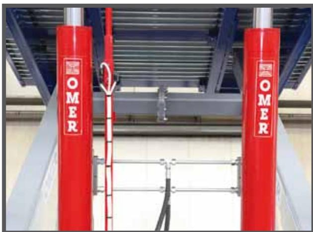
На левом поршне имеется планка, на которой установлены концевые выключатели трех различных типов. Положение этих выключателей можно отрегулировать в соответствии с необходимой высотой подъема.
