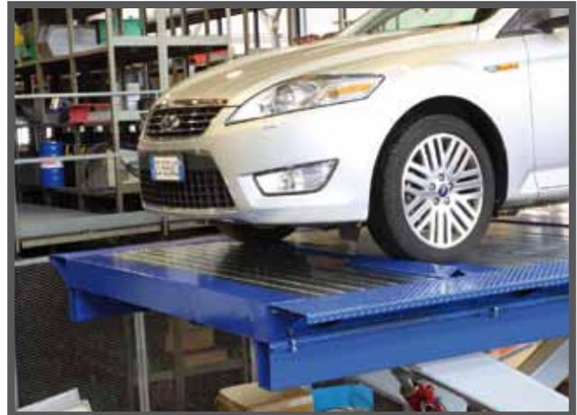
Обратите внимание на упор для колес (в стандартной комплектации), который обеспечивает надлежащее положение передних колес автомобиля. Этот элемент конструкции обеспечивает безопасность, предотвращая неожиданные перемещения автомобиля во время ее движения. Еще один такой упор находится в задней части платформы.
