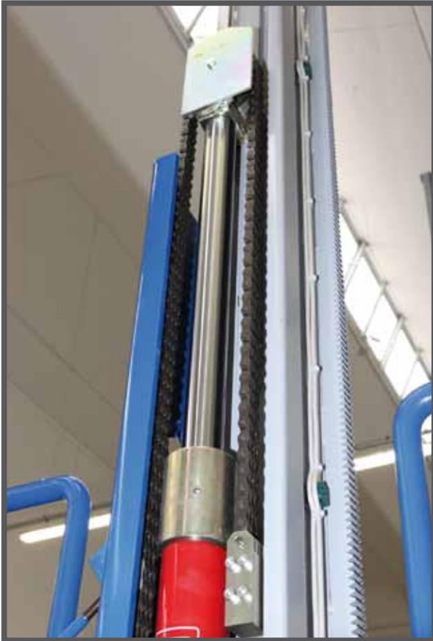
Система Move 30 N оснащена поршнем (производитель - компания OMER S.p.A.) и цепью (соотношение 1:2), которая позволяет вдвое увеличить ход платформы по сравнению с длиной шахты.
