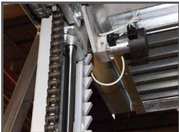
Кроме того, система оснащена электромагнитной блокировочной системой с зубчатой рейкой, которая позволяет перевести платформу в безопасный режим на любой высоте. Такая система имеется на каждой колонне.
