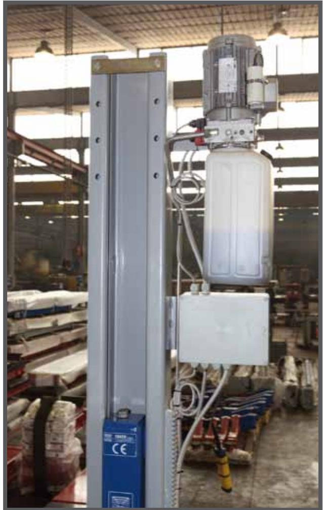
Компактные размеры гидростанции и электрической панели, которые находятся в верхней части левой опоры, обеспечивают непревзойденную эффективность системы при минимальных требованиях к занимаемой площади, а также возможность беспрепятственной парковки автомобиля.
