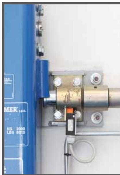
На этих фотографиях показан механический стопор, предназначенный для блокировки платформы на уровне остановки.
