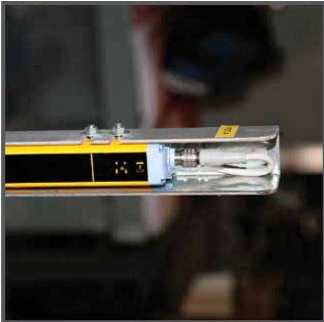
На этой фотографии изображен фотоэлемент, расположенный внутри оцинкованного корпуса, который защищает как фотопередатчик (и фотоприемник), так и подведенную к ним электропроводку.
