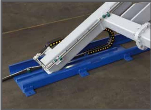
Все шланги и провода системы закрыты специальными кожухами, которые защищают их от неожиданных или чрезмерных перегибов и предотвращают их поломку. Как можно увидеть, опоры скользят по двум продольным каналам, которые неподвижно закреплены на полу механическими анкерами. Форма этих каналов специально подобрана таким образом, чтобы предотвратить выскальзывание опор в случае возникновения неравномерных напряжений во время работы.
