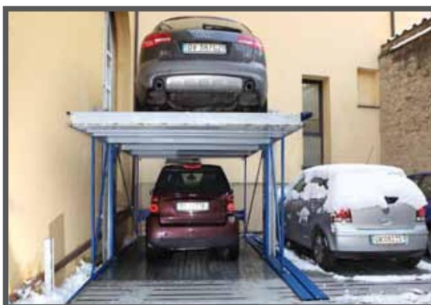
Как и система Move 20+20/2, система Move 20 оснащена механическим блоком с гидравлическим приводом, который расположен в верхней части колонны и обеспечивает безопасность.
