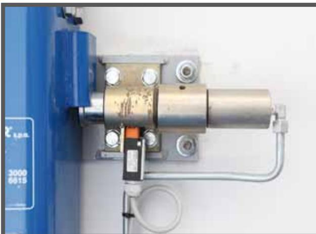
Поршень, которые обеспечивает механическую блокировку системы на уровне остановки, работает под управлением концевого выключателя, который определяет положение платформы.
