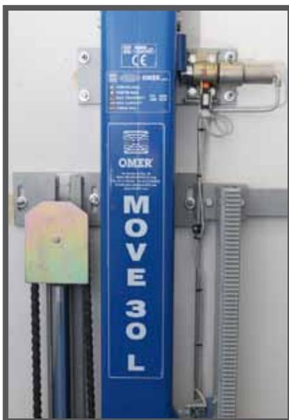
На верхнем этаже поршневой блок, направляющие и стопорные механизмы выступают на 1618 мм над уровнем пола.
