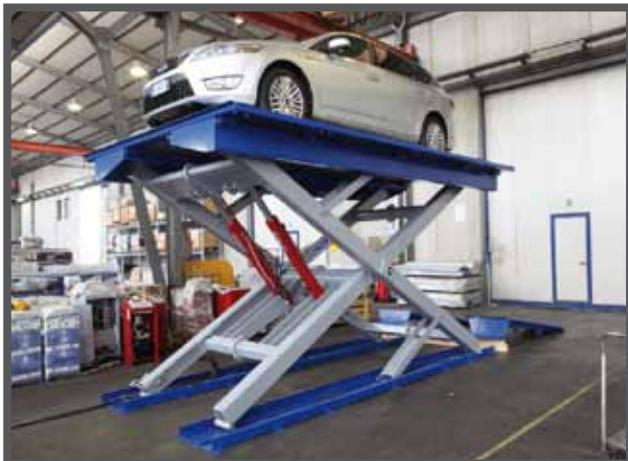
Максимальная высота подъема платформы REX Gold 30 над уровнем пола составляет 4.10 м, а стандартная грузоподъемность - 3000 кг (может быть увеличена до 4000 кг). Благодаря симметричности подъемника вес не требуется располагать равномерно относительно его центральной линии. Поэтому платформу можно использовать как для подъема автомобилей, так и для подъема грузов.
