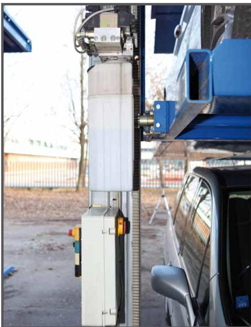
Пульт управления может быть расположен на одной из опор, либо в ином месте, выбор которого может определяться требованиями пользователя или удобством работы с системой.
