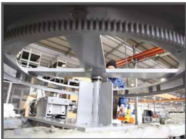
Круглая зубчатая рейка закреплена на несущей конструкции платформы, которая установлена на центральный поворотный штырь.
