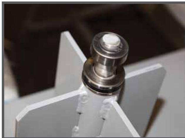
Центральный поворотный штырь является частью привода. Вес платформы приходится на упорный подшипник, который полностью компенсирует ее сжатие под действием веса.
