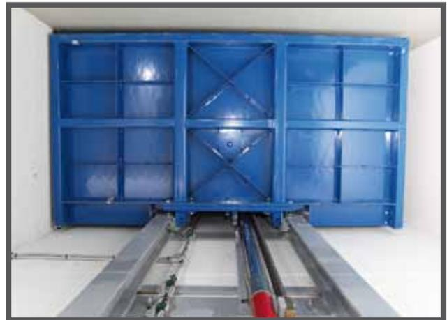
Платформа состоит из пересекающихся трубчатых профилей, которые проходят вдоль всей ее длины и обеспечивают платформе значительную жесткость. Благодаря этому система имеет большую грузоподъемность (до 1500 кг).
