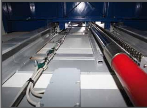
Основные элементы системы, в том числе - все электрические соединения и распределительная коробка, расположены между колонн. Благодаря этому они легко доступны для периодического технического обслуживания.
