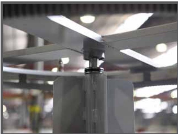
Несущая конструкция устанавливается на центральный поворотный штырь, закрепленный в прямке.
