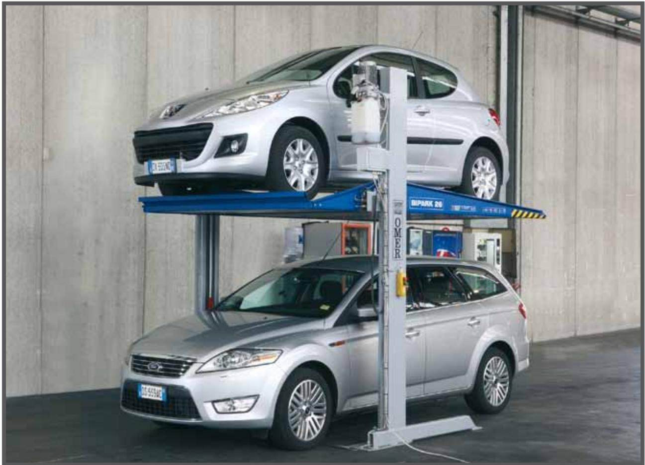
Уникальный стопорный механизм с торсионным валом, с которым жестко совмещена шестерня зубчатой передачи, и собачкой, перемещающейся под действием электромагнита, обеспечивает надежную фиксацию платформы на любой высоте, в том числе после опускания из крайнего положения.
