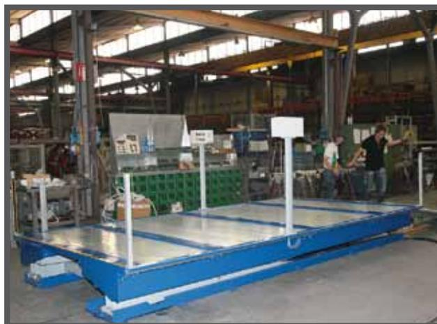
В серию пантографных подъемников входит система, допускающая нахождение людей в автомобиле при подъеме. Эта возможность может быть удобной в тех случаях, когда высота подъема не превышает 4 м, либо и нет возможности организовать анкерное крепление к стенам.
