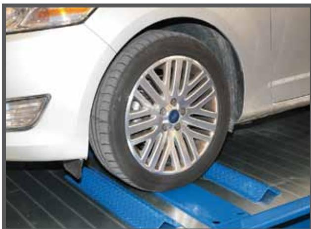
Среди других элементов конструкции подъемника необходимо выделить упоры для колеса, расположенные на платформе и обеспечивающие полную безопасность находящегося на ней автомобиля. Благодаря этим упорам исключается раскачивание автомобиля в продольном направлении.
