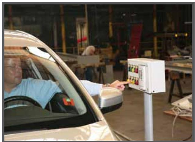
Пульт управления расположен таким образом, что после остановки автомобиля водитель может легко дотянуться до кнопок через окно и управлять подъемником, не вставая с удобного водительского сиденья.
