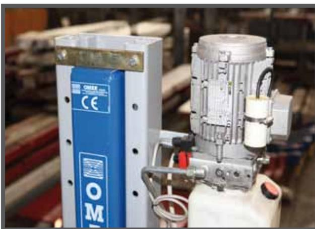
Высота подъема платформы устанавливается во время начальной настройки системы при помощи стопорных стальных пластин, которые устанавливаются в верхних частях опор. Благодаря этому можно установить максимальную
