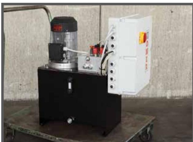
Для того чтобы сделать конструкцию системы в целом еще более компактной, гидравлический блок - электрогидравлический насос и масляный резервуар - встроены в щит питания системы.
