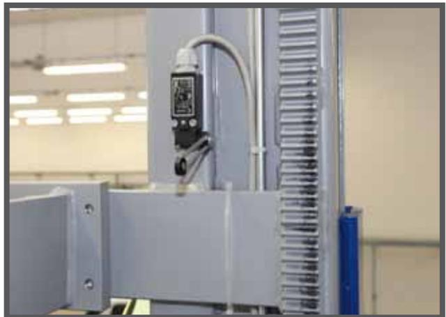
Другой концевой выключатель выполняет еще одну крайне важную функцию: управление торможением. Благодаря его работе платформа подходит к точке назначения плавно, без резких движений.
