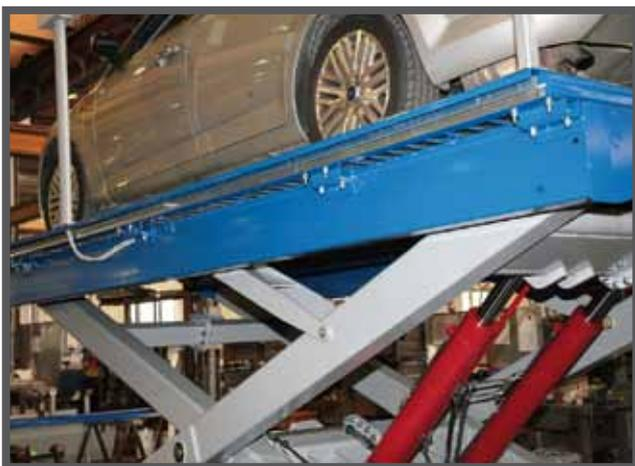
Электропроводка, соединяющая пульт управления и электрический щит подъемника, проходит по специальным алюминиевым кабельным каналам, которые защищают ее от повреждений, а также от несанкционированного подключения. На фотографии можно видеть, насколько аккуратно изготавливаются эти системы.
