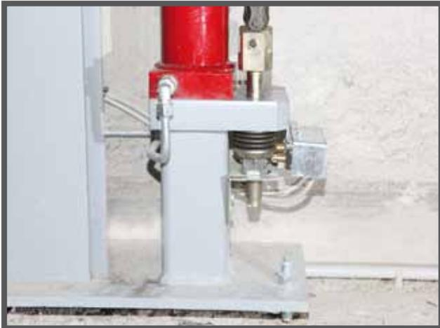
Система концевых выключателей, расположенных в основании поршня, управляет натяжением подъемных цепей (по две на каждый поршень) и обеспечивает блокировку платформы при появлении неисправности или при обрыве одной из них.
