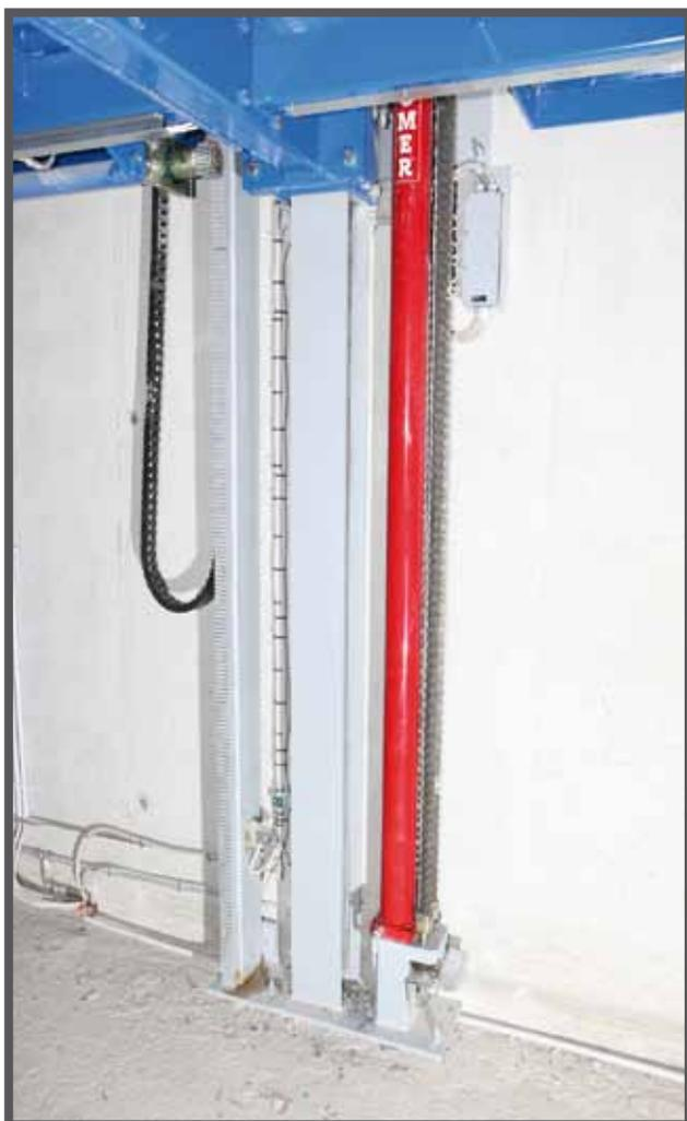
На этой фотографии показана опора с подъемным цилиндром (производитель - OMER S.p.A.), зубчатая рейка с торсионным валом, кожух, защищающий силовые кабели платформы, а также электрическая распределительная коробка.
