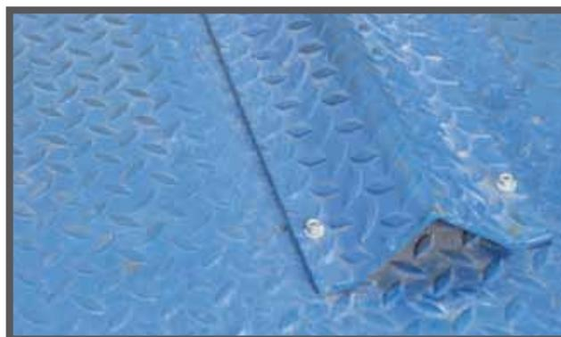
Упор для передних колес гарантирует, что автомобиль установлен надлежащим образом и не сместится во время перемещения платформы. Еще один такой упор находится в задней части платформы.
