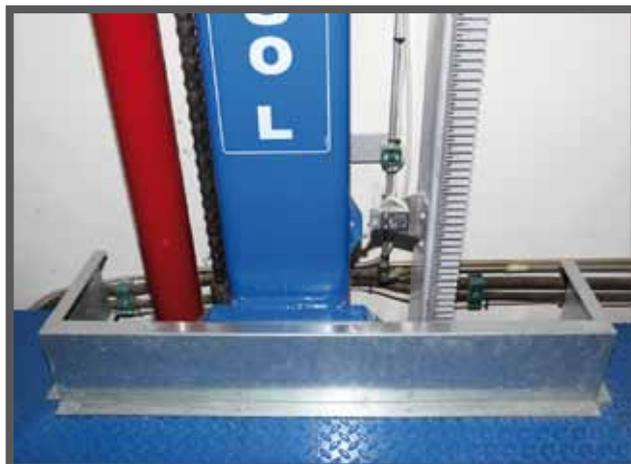
Фотография показывает работу концевого выключателя остановки, который находится на опоре напротив концевого выключателя торможения, но имеет более короткий рабочий кулачок.
