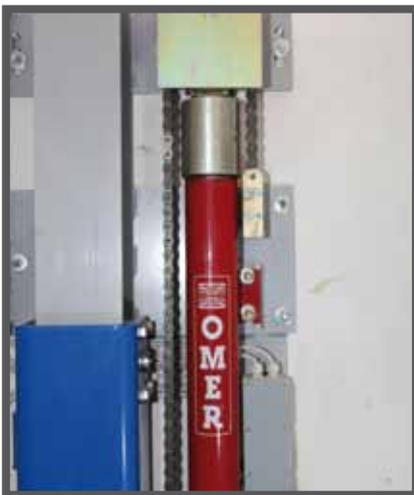
На этих фотографиях показано крепление колонн к стене, которое осуществляется при помощи пластин, приваренных к опорам на заводе-изготовителе, и химических анкеров. Кроме того, здесь
