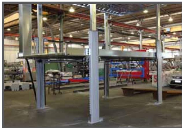
Выпускается три модификации системы Duplo: Duplo 30 T, Duplo 25/2 и Duplo 20/2 T. Все эти системы полностью оцинкованы, включая платформу и крышу.
