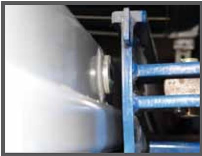
Система оснащена механизмом, который механически блокирует платформу и гарантирует, что она не изменит своего положения. Блокировка осуществляется поршнем, который выступает из колонны под действием гидравлического давления.
