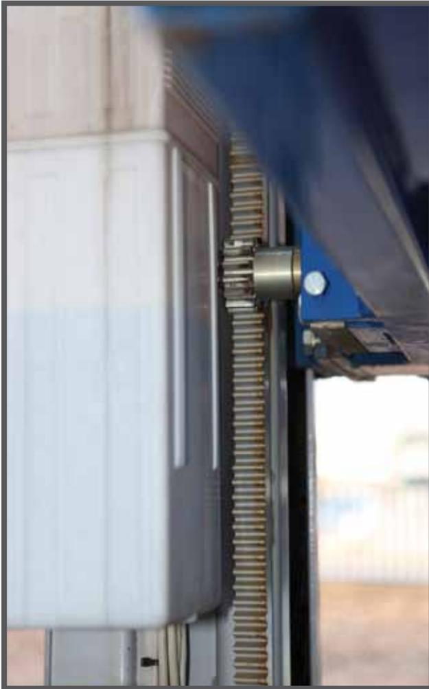
В систему торсионного вала входят две зубчатые рейки (по одной на каждую из колонн платформы), две шестерни с углублениями (по одной с каждого конца вала), а также собственно торсионный вал.
