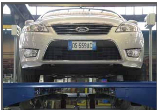
Одной из основных особенностей изделий компании Omer SPA является идеальная балансировка веса на платформе, которая достигается независимо от того, как именно расположен груз. Благодаря специально разработанной конструкции, эти системы, в частности - TOTAL REX, обеспечивают подъем платформы при сохранении ее параллельного положения относительно пола, без каких-либо перекручиваний или перегибов.
