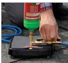
Адаптер для баллона 1/4" SAE для подключения малых баллонов с хладагентами 1 л и 2 л.
