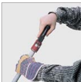
Простое снятие грата с использованием рукоятки
