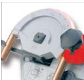
Предварительная установка угла гибки без использования инструмента
