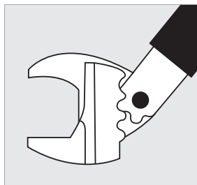
Головка ключа в полностью открытом состоянии
