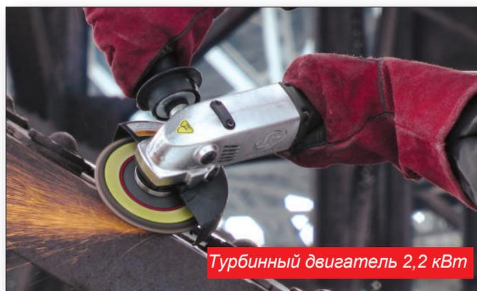
Турбинный двигатель 2,2 кВт
