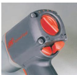
Кнопки хода вперед-реверса и регулятор мощности на гайковерте серии 2100MAX
