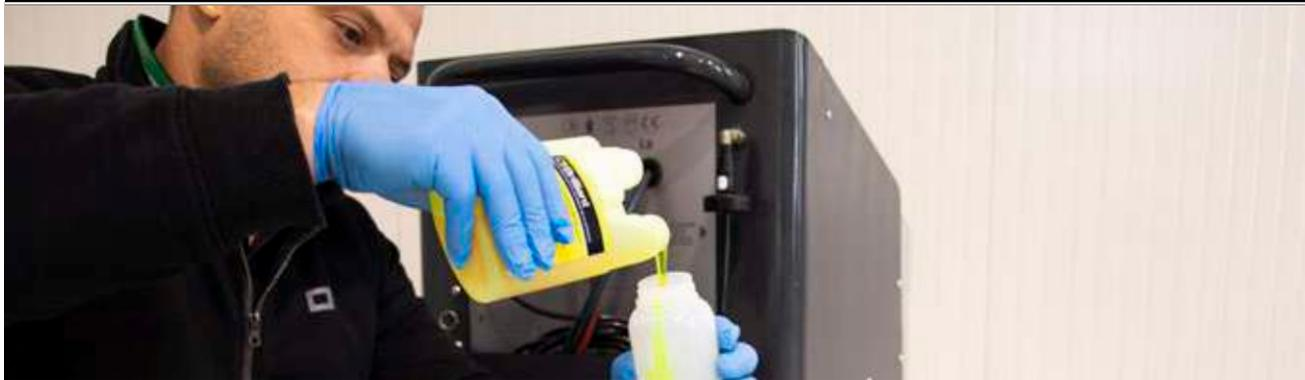
Ультрафиолетовые красители позволяют быстро и безошибочно определить места утечек хладагента в автомобильной системе кондиционирования. После введения продукта в систему, краситель будет виден на месте утечки под воздействием УФ-лучей.
